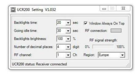
Ferner wird in diesem Fenster nicht nur die aktuelle Signalstärke der Funkverbindung angezeigt, sondern auch, ob die Funksteuerung eine Verbindung zum Empfänger aufbauen konnte.
