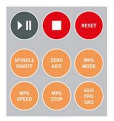
Der obere rechte Bereich auf dem LCD-Bildschirm zeigt den aktuellen Status der Steuerungssoftware, die Signalstärke der Funkfrequenz und den Ladestatus der sich in der Funksteuerung befindenden Batterien an. Hierunter werden der Vorschub und die Drehzahl der Spindel angegeben sowie die Verfahrparameter im MPG-Modus (Multi-Pulse-Generator). Durch die Betätigung der Taste "MPG Mode" können Sie zwischen dem MPG- und dem normalen Bearbeitungsmodus umschalten.
